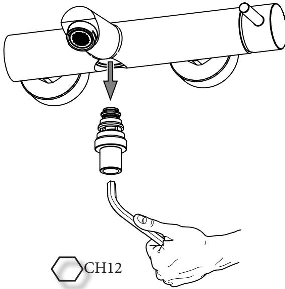
**d** Sostituzione Aeratore
