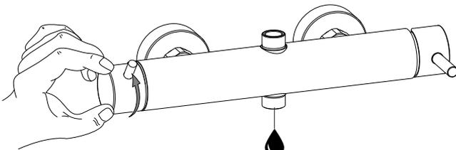
Cambiando la selezione dell'uscita si verifica un gocciolamento da entrambe le uscite come sicurezza, al fine di non dimenticare il miscelatore aperto ed evitare di esporre il deviatore a pressioni non idonee.
